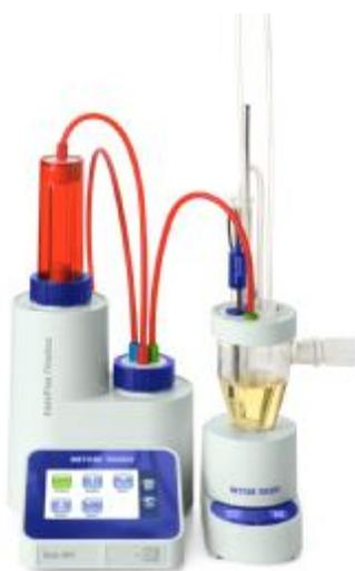
Рисунок 4 - Внешний вид титратора Easy KFV
